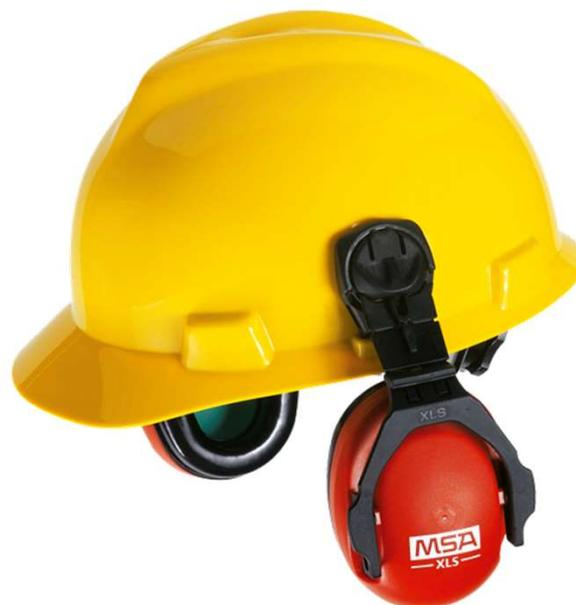
O abafador de ruídos para uso com capacete V-Gard XLS - Tipo Kit é composto por duas conchas de ABS, duas espumas internas de PU - Poliuretano, garfo acoplador em PA6.6 - Poliamida com fibra e haste metálica em aço mola (somente na parte interna da haste), e atenuação de 20dB NRRsf. Confortável e flexível proporciona melhor ajuste à , além de excelente vedação e máxima proteção ao usuário.
