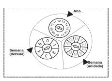
INICIO DE USO: BEGINNING OF USE: O lote de fabricação dos capacetes V-Gard é marcado em forma de relógio na aba dos capacetes na parte interna dos cascos e no modelo sem aba é gravado na parte interna do casco semana/ano.
